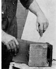
Fig. 225. Inserting Separators
